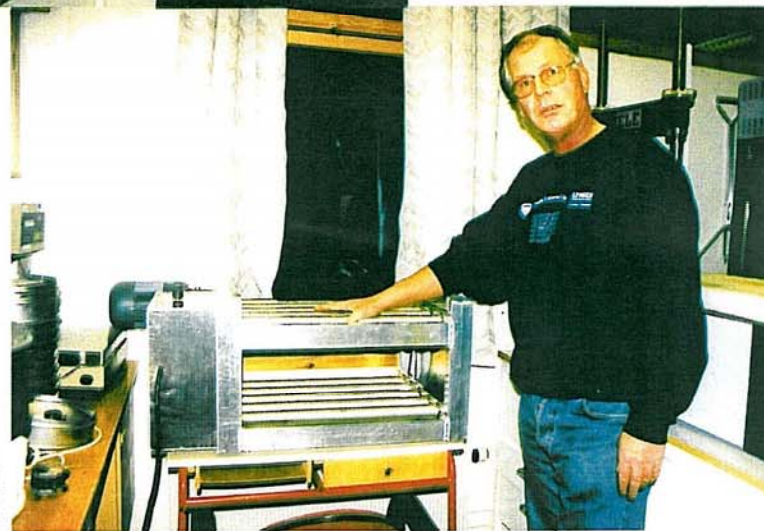
Rullebordet. Her testes bindemiddelets vedhefteegenskaper til steinmaterialet
