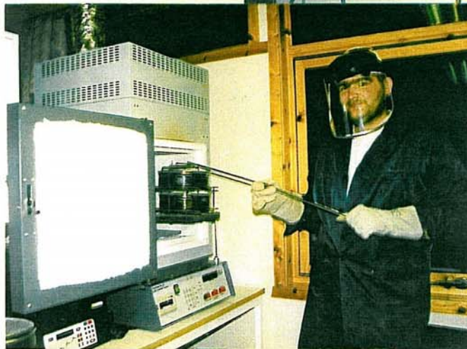
Jan Ivar Larsen i full gang med analysering av asfalt med den nye forbrenningsovnen.
