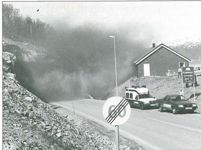
Full røykutvikling på Kvaløysida da det var brannøvelse i Kvalsundtunnelen.
