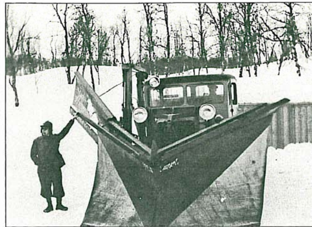
FW.D. (Amerikansk bygget brøytebil) Utstyrt med «Sargent» forplog m/ hydraulisk løft og sideplog – 1927.
