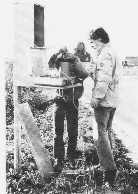
Ved "tapping" av data fra trafikk-telleren brukes datakofferten. Kjell Vang til høyre.
