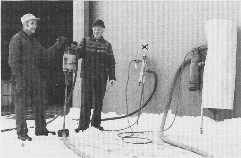
Forslagsstilleren til høyre sammen med Knut Thune. Vannutskilleren (merket med kryss) er den nye forbedringen på støvsamleren.
