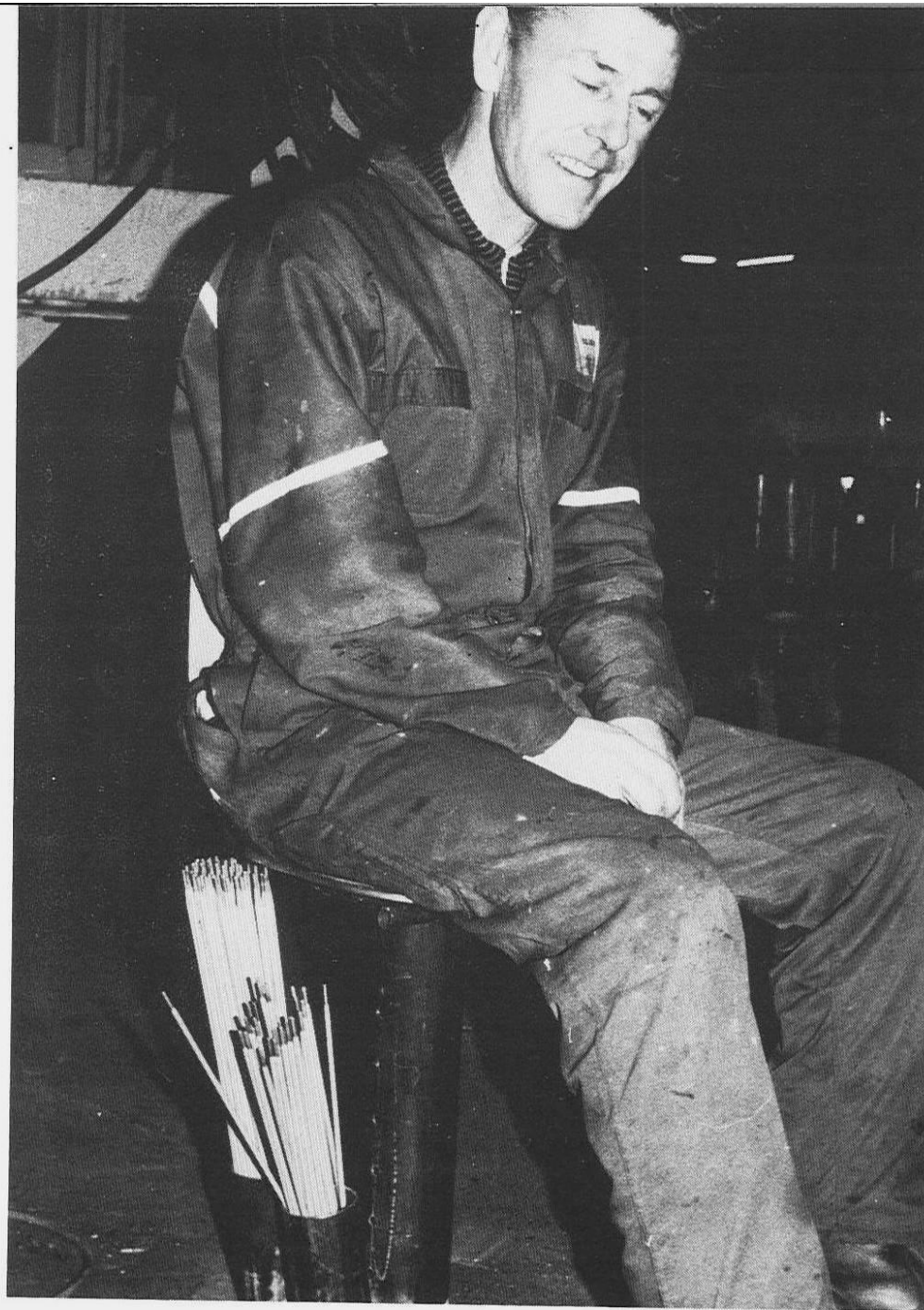
EN PRAKTISK SVEISESTOL har de laget seg på verkstedet i Åsegarden ved Harstad. Svingbart sete og 2 beholdere for sveiseelektroder hører med. Einar Eriksen (bildet) har bare godord om stolen.
