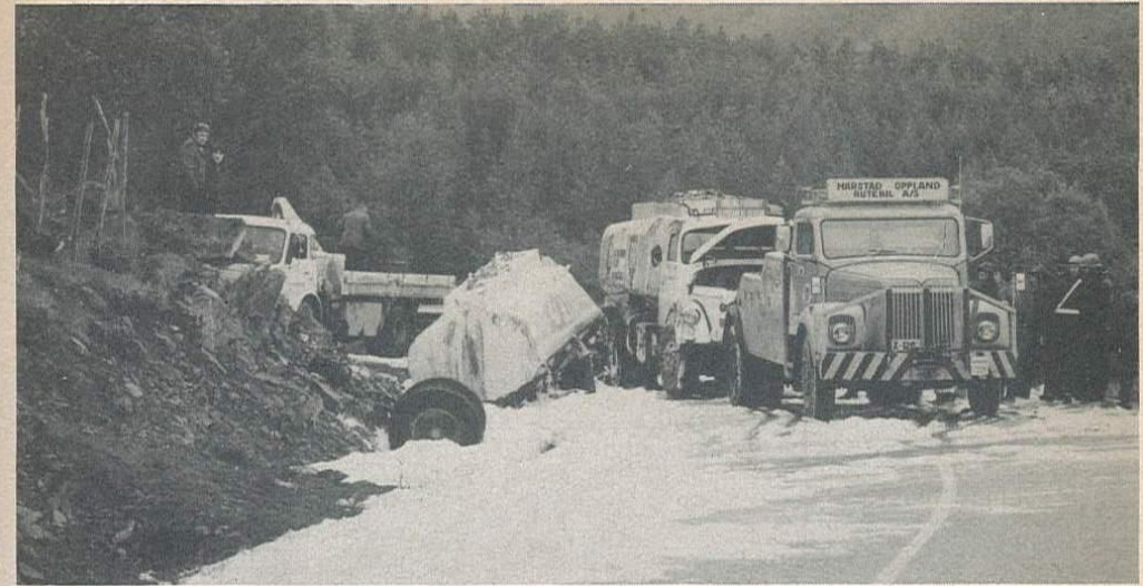
Fra bergingsarbeidet — vegbanen er skumlagt
