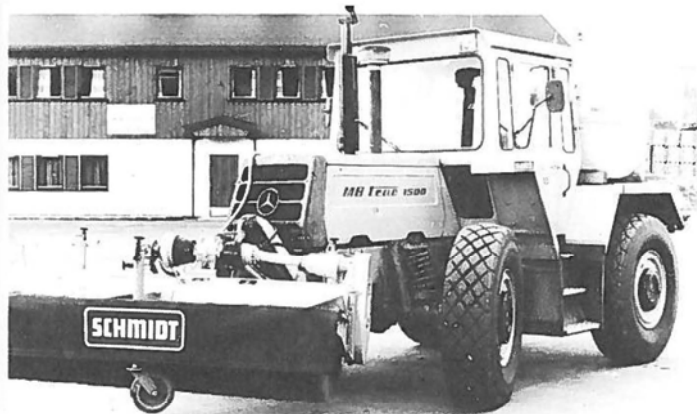
MASKINAVDELINGENS nyervervede traktor på Finnsnes har et allsidig bruksområde – snøfresing, frontskjær for snørydding, feiekost m/vannspylar, kantklipper – fullt utstyrt nærmere 1,0 mill. kr. Nedenfor UTRYKKING fra Bardu vegstasjon for reparasjon av borevogn på Tjuvskjær – Kjell Abrahamson.
