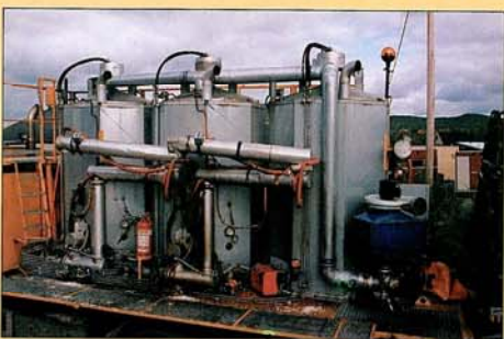
Magnetiseringsprosessen foregår i den blå boksen plassert bak på kokebilen.
