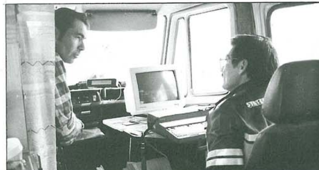
Oppsynsmann Jon Martin Aronsen gir opplæring til Matthis Pettersen i bruk av datautstyret for måling av vegens bæreevne.
