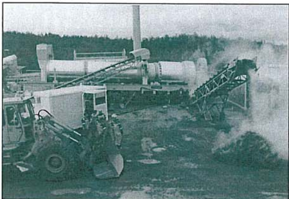
Den rykende ferske masse fra det nye asfaltverket. Nå kan en større del av oppfrest masse fra gammelt dekke utnyttes. (Foto: Karl S. Foslund)
